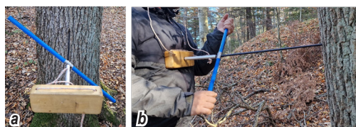
Figura 3 a. Pieptar folosit pentru asigurarea stabilității și menținerii orientării burghiului. b. Utilizarea pieptarului a. Starter used for ensuring the stability and maintaining the orientation of the borer b. Use of the breastplate
