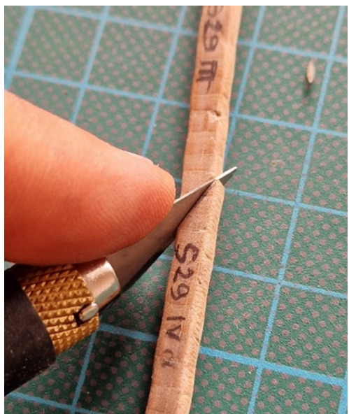
Figura 7 Secționarea probelor în segmente de 4-5cm lungime Sectioning the samples into segments of 4-5 cm in length
