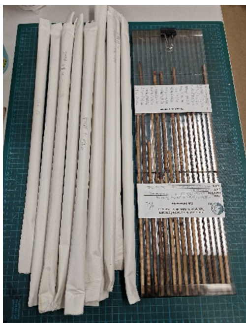
Figura 5 Containere pentru probe (15 tuburi de hârtie și o placă de policarbonat cu 15 canale) Containers for samples (15 paper tubes and a polycarbonate plate with 15 channels)
